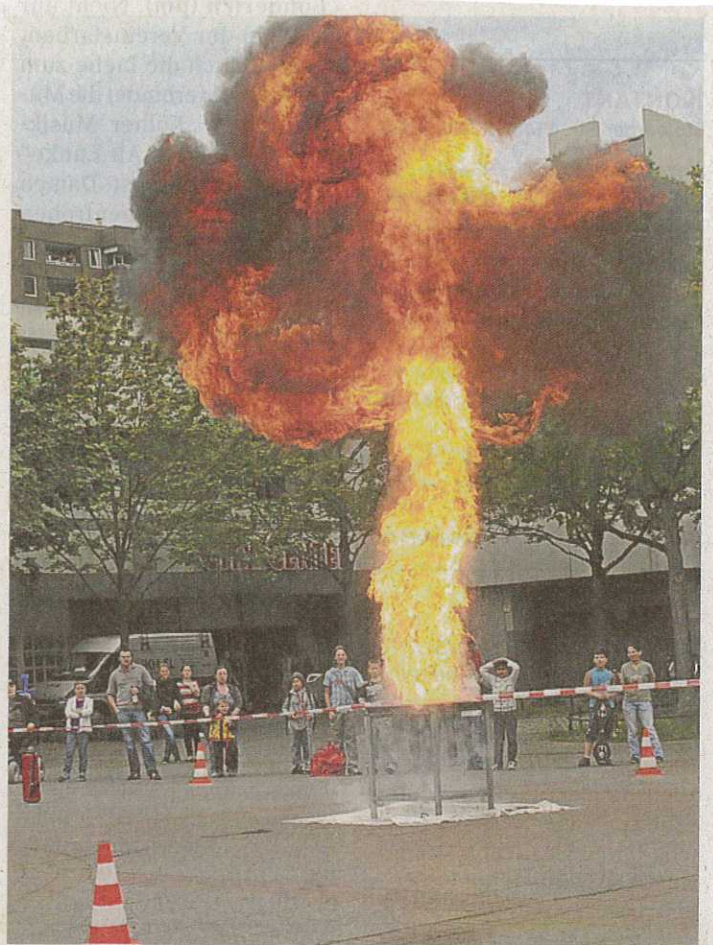
■ Eindrucksvoll war die Demonstration bei der versucht wurde, brennendes Öl mittels Wasser zu löschen. Foto:pk
